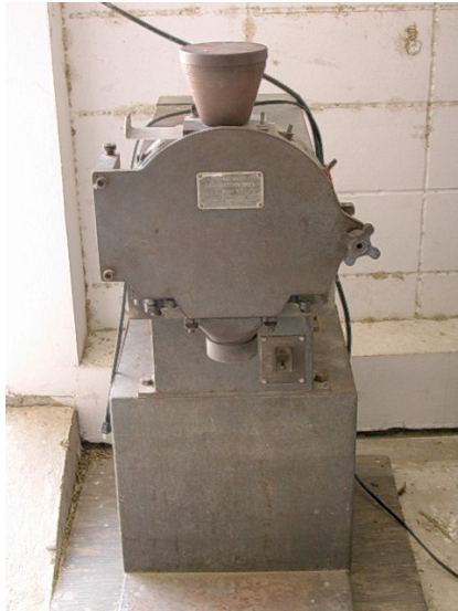
รูปที่ 3 เครื่องบดอาหารสัตว์ แบบ Cutting mill
