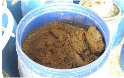
ภาพที่ 1 การนำกากตะกอนน้ำมันปาล์มมาหมักยีสต์
