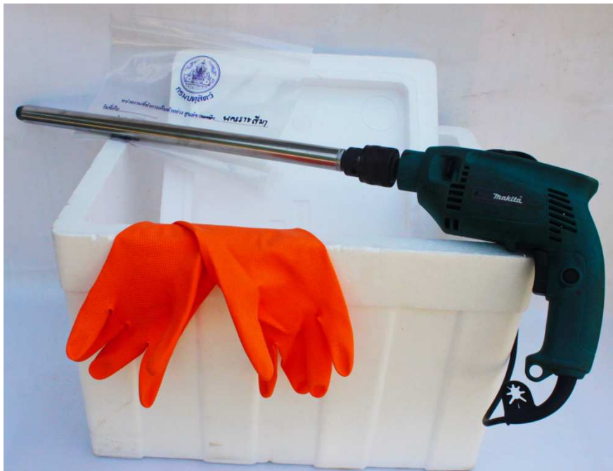
รูปที่ 19 วัสดุ อุปกรณ์ การสุ่มและเตรียมตัวอย่างอาหารหยาบหมัก
