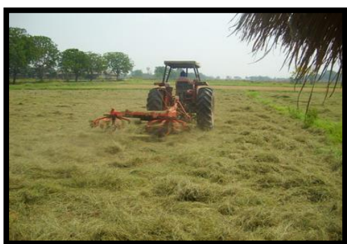
ภาพที่ 10 การเกลี่ยสับตมเพื่อตากหญ้า และการเกลี่ยรวมกองเป็นแถวเมื่อหญ้าแพงโกลาแห้ง
