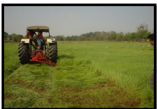
ภาพที่ 9 การตัดหญ้าแพงโกลาด้วยเครื่องจักร ดรัมโมเวอร์
