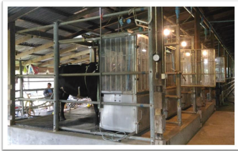
ภาพที่ 3.6 คอกสัตว์ พร้อมตู้ และ Hood สำหรับวัดค่าการหายใจของสัตว์
