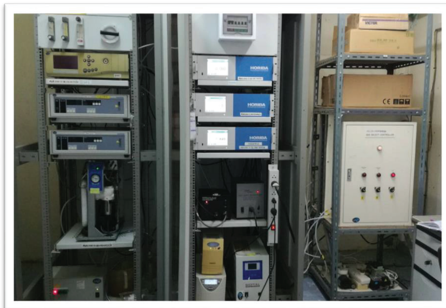
ภาพที่ 3.7 เครื่องวัดก๊าซ Oxygen analyzer Carbon dioxide analyzer Methane analyzer และชุดควบคุมการไหลของอากาศ
