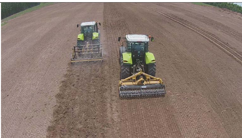
ภาพที่ 7 รถไถดินให้ละเอียดด้วยจอบหมุนและตามด้วยจานพรวน
