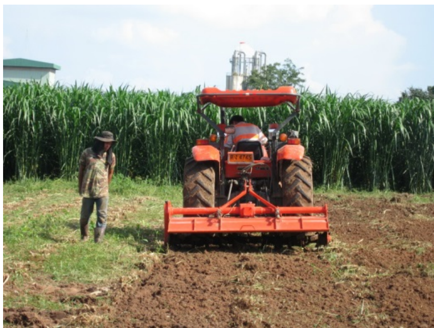
ภาพที่ 49 การใช้จอบหมุนพรวนดินหลังจากแต่งต่อหรือตัดรากเก่า
