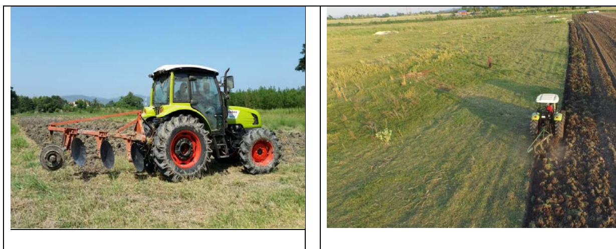
ภาพที่ 5 ไถเปิดหน้าดินผาน 3 หรือ 4 จาน
