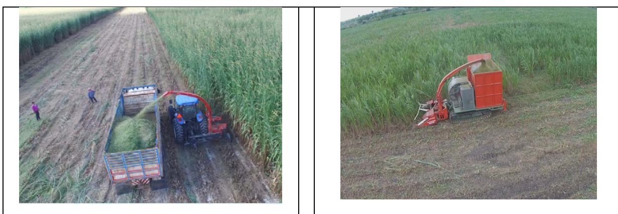
ภาพที่ 44 เครื่องเก็บเกี่ยวหญ้าเนเปียร์แบบต่อ เพลลาอำนาจกำลังกับรถแทรกเตอร์เกษตร
