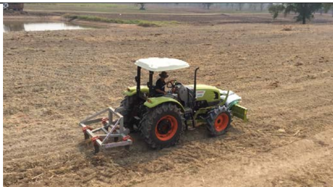
ภาพที่ 6 รถไถใช้รีปเปอร์ไถระเบิดดินดาน
