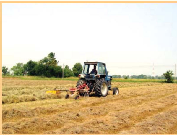
การเกลี่ยกระจายกองหญ้า โดยเครื่องสับตีฟ้ง
