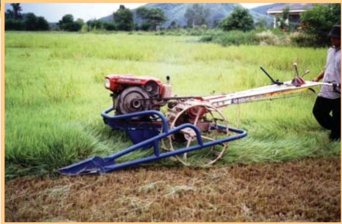
เครื่องตัดหญ้าแบบ ปัดตาเลี่ยนติดกับรถ ไถเดินตาม
