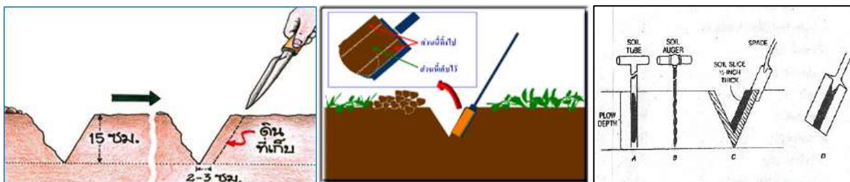
ภาพผนวกที่ 3 แสดงวิธีการขุดหรือเจาะเพื่อเก็บตัวอย่างดิน
