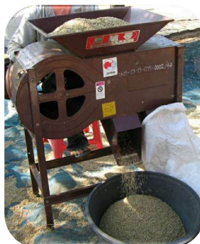
ภาพที่ 48 เป่าแยกเมล็ดลีบ โดยใช้เครื่องสีฟัด หรือตะแกรงร่อน
