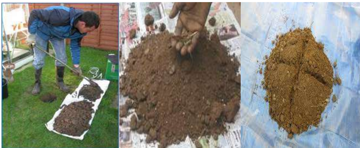
ภาพผนวกที่ 4 ตัวอย่างดินที่เก็บมาต้องผึ่งให้แห้งในที่ร่ม ห้ามตากแดด หรืออบด้วยความร้อน
