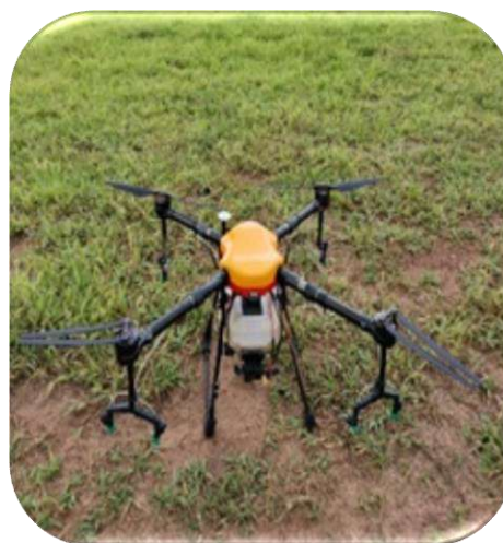
ภาพที่ 31 กำจัดวัชพืชใช้โดรนพ่นสารเคมี
