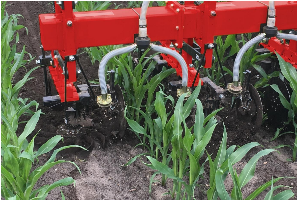
ภาพที่ 6 การฉีดมูลสัตว์เหลวเข้าสู่ใต้ผิวดินในแปลงข้าวโพด
