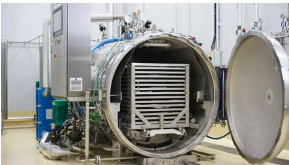
ภาพที่ 7.8 เครื่องฆ่าเชื้อที่ใช้ความร้อนแบบสเตอริไลซ์ (อาหารกระป๋อง และ Retort Pouch)
