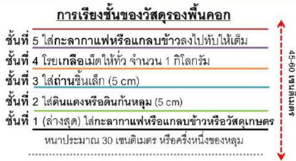
ภาพที่ 1.4 แสดงการเรียงของชั้นของวัสดุรองพื้นหลุม
