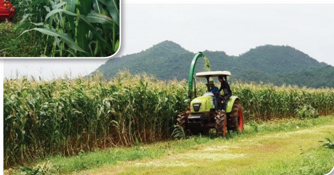
ภาพที่ 11 การเก็บเกี่ยวต้นข้าวโพดพร้อมฝักโดยใช้เครื่องจักร double chop
