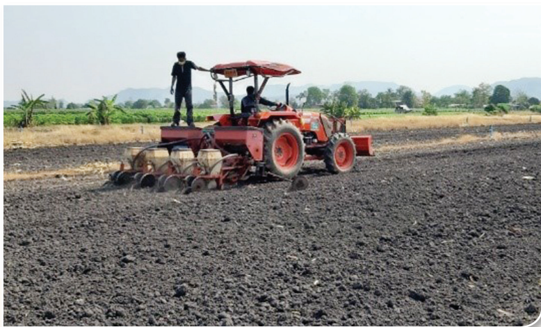
ภาพที่ 7 ปลูกโดยการหยอดเมล็ดพร้อมใส่ปุ๋ยรองพื้น ด้วยเครื่องปลูกระบบ pneumatic
