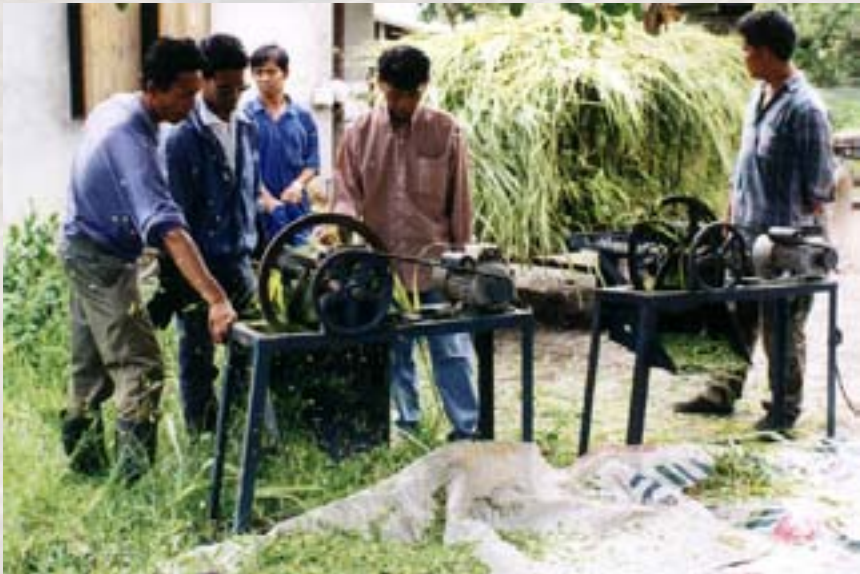
การใช้เครื่องหั่นหญ้าให้มีขนาด 2-3 เซนติเมตร
