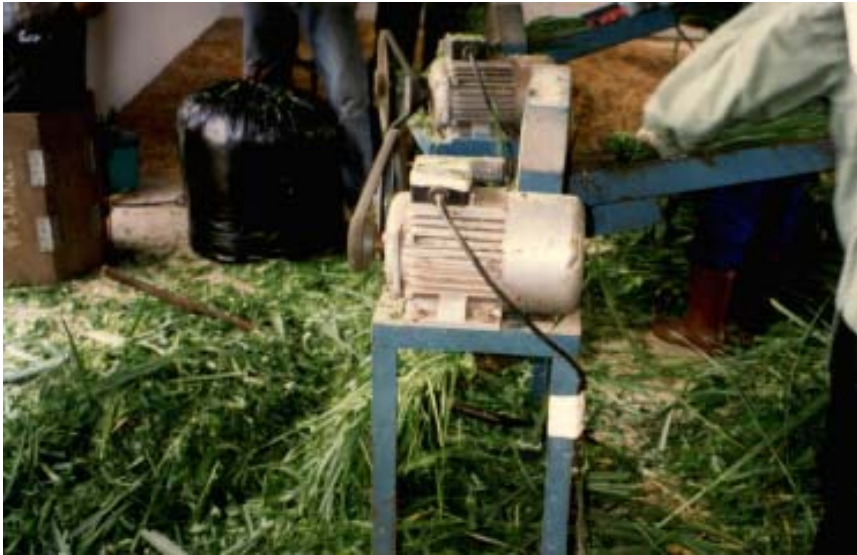
การใช้เครื่องหั่นหญ้าให้มีขนาด 2-3 เซนติเมตร
