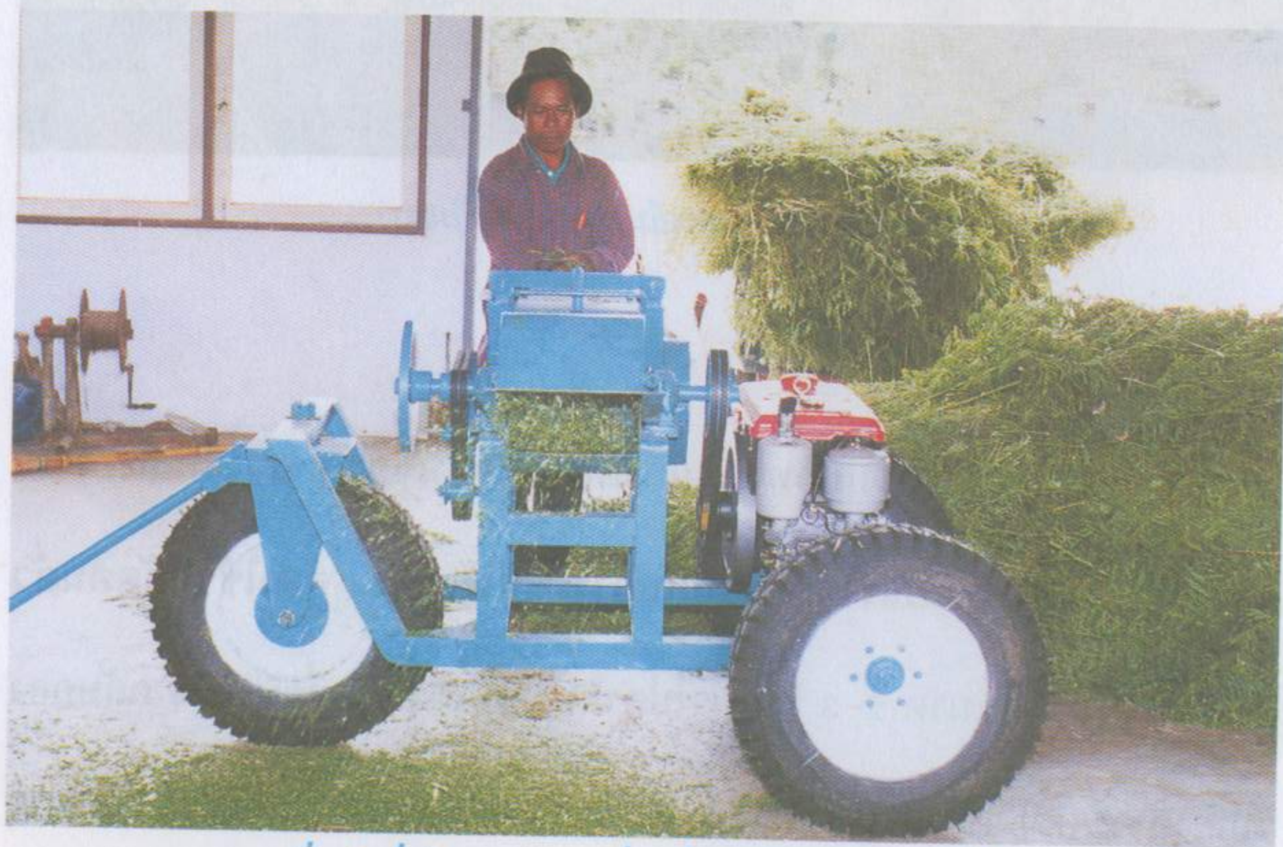
การหั่นต้นหญ้าไมยราด้วยเครื่องหั่นก่อนนำไปตากทำฉั้วแห้ง
