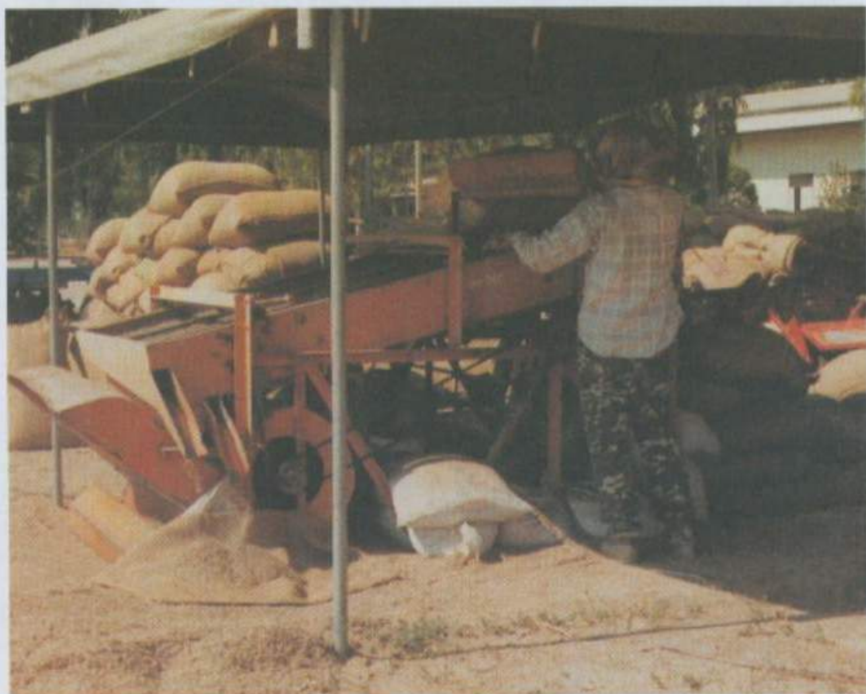
การใช้เครื่องทำความสะอาดเมล็ดพันธุ์แบบมีตะแกรงและลมเป่า
